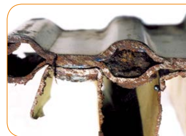
Zugesetzte Heizkörper aufgrund von Ablagerungen
